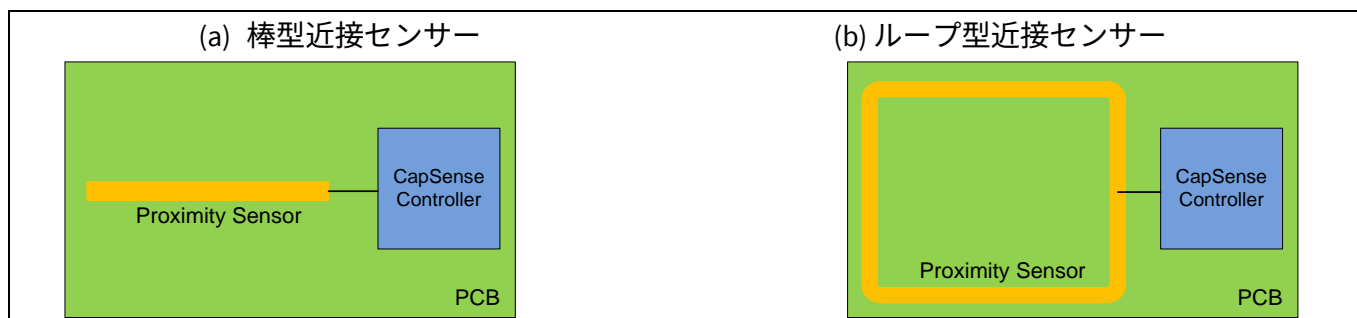
Figure 87 プリント基板配線時の CAPSENSE™ベースの近接センシング
