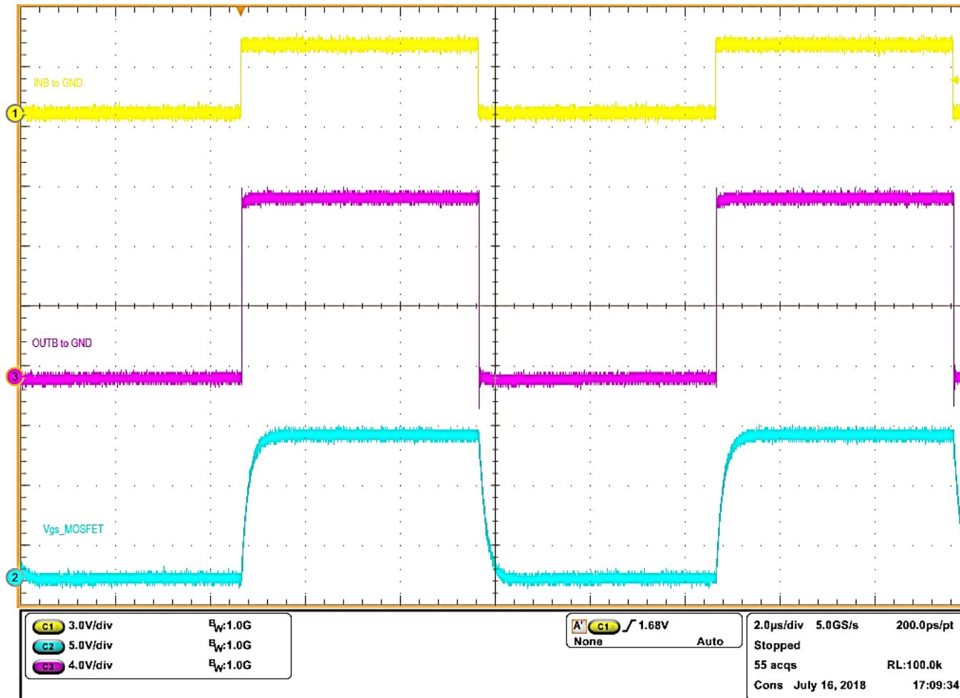
➤ 在单个 MOSFET 上进行测量  $V_{DS} = 0 V$  (漏极和源极短路)
