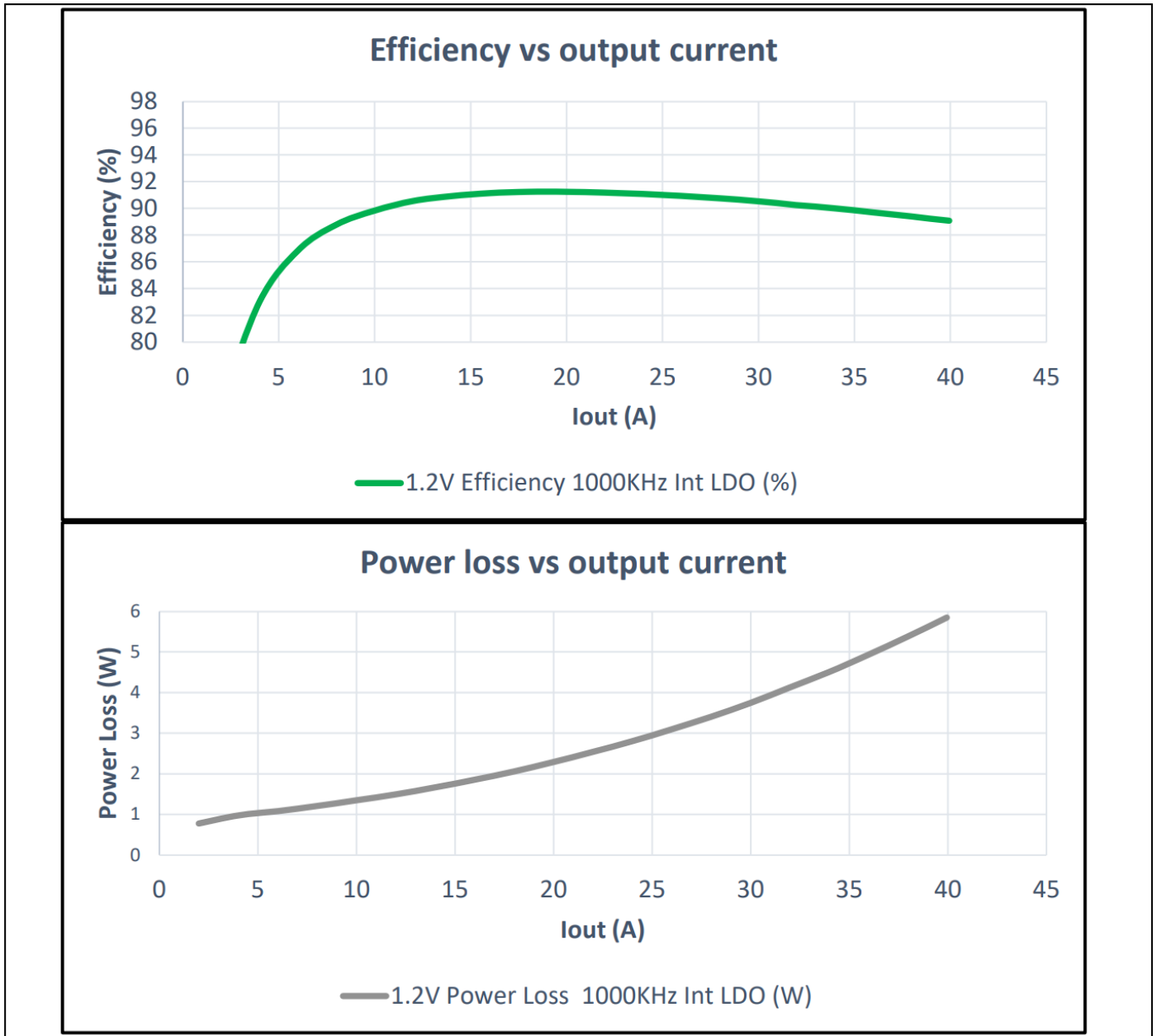
图9 典型效率和功率损耗曲线, P_{V_{in}} = V_{in} = 12\text{ V} 、 V_{out} = 1.2\text{ V} 、 F_{sw} = 1000\text{ kHz}
