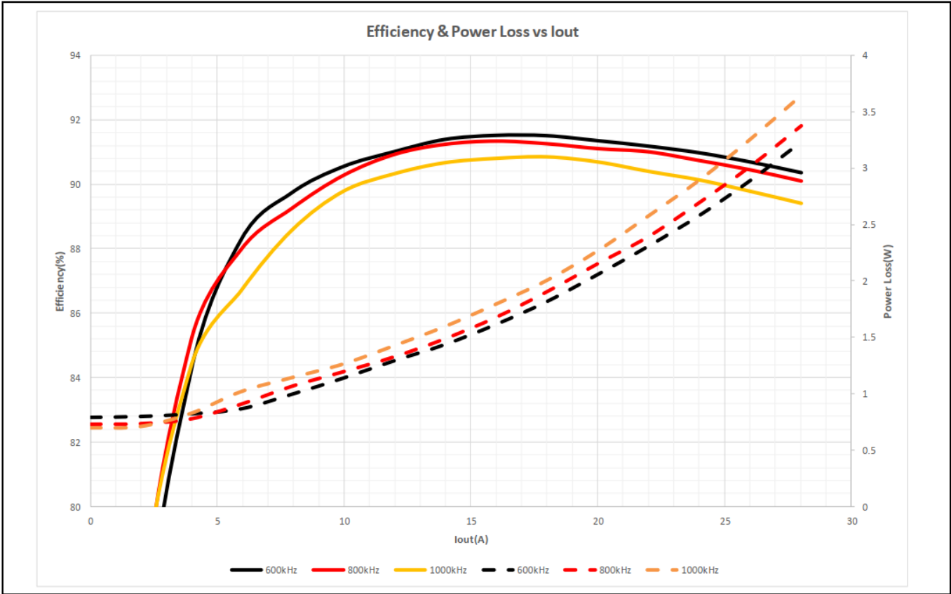
图 6 典型效率和功率损耗曲线， P_{Vin} = 12\text{ V} 、 F_{sw} = \text{变化}
