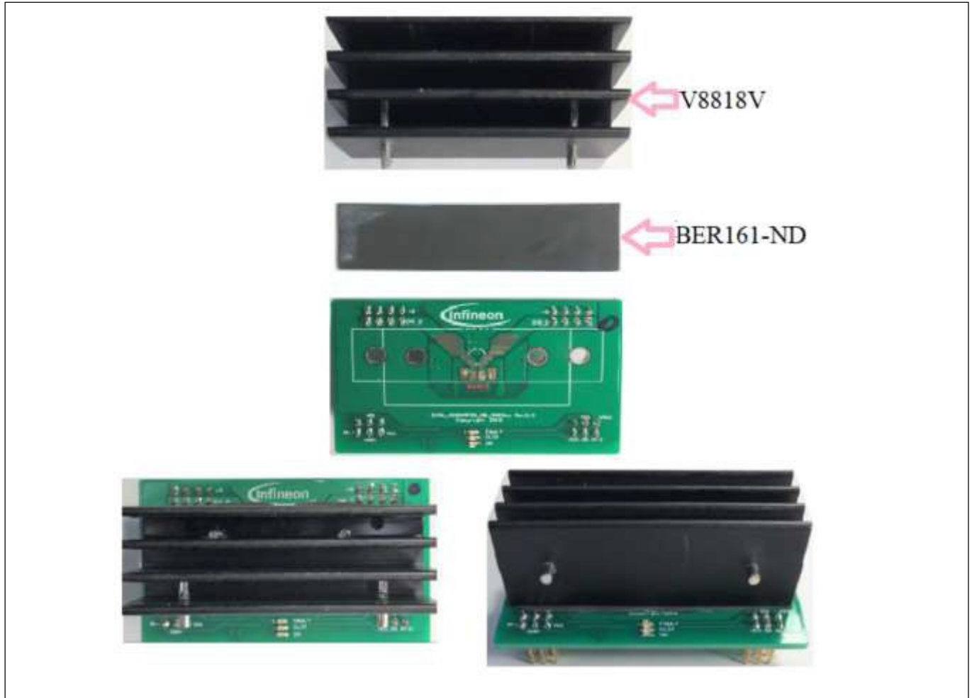
图 21 散热器安装
