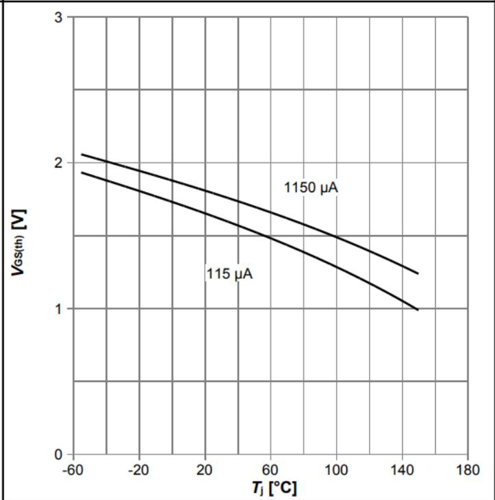
$V_{GS(th)}=f(T_j)$ ,  $V_{GS}=V_{DS}$ ; parameter:  $I_D$
