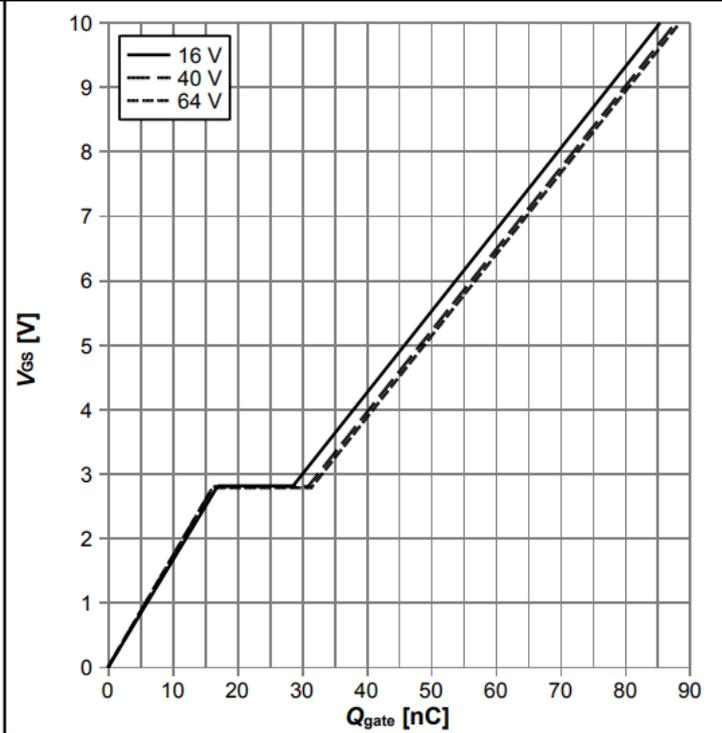
$V_{GS}=f(Q_{gate}), I_D=50 \text{ A pulsed}, T_j=25 \text{ °C}$ ; parameter:  $V_{DD}$
