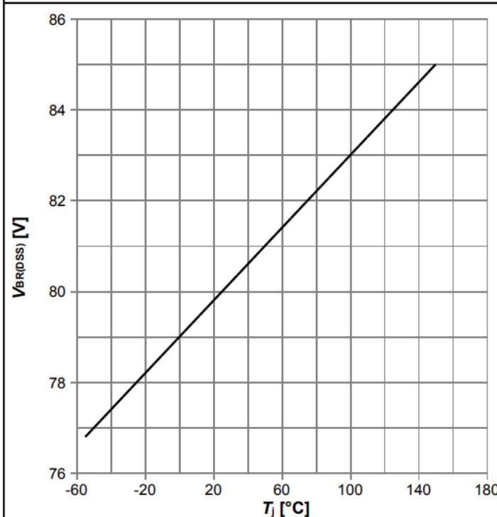
$V_{BR(DSS)}=f(T_j); I_D=1 \text{ mA}$
