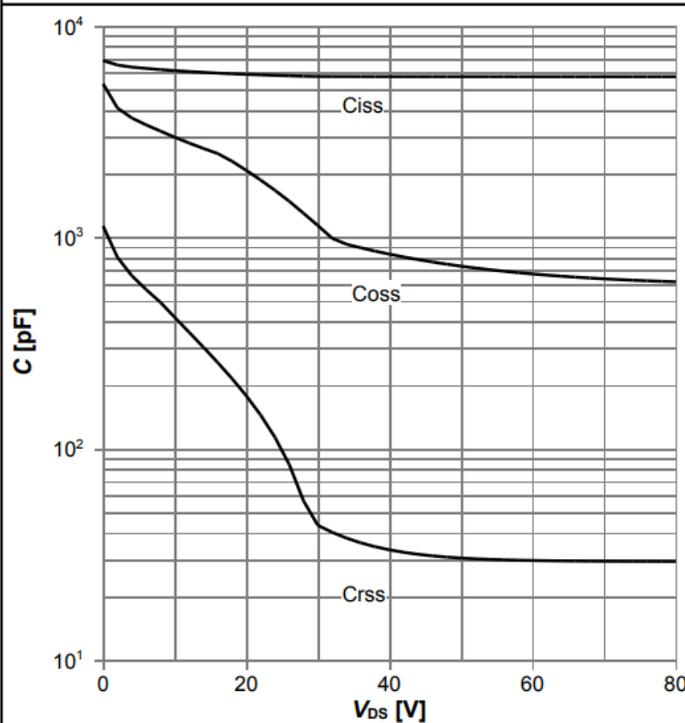
$C=f(V_{DS})$ ;  $V_{GS}=0$  V;  $f=1$  MHz
