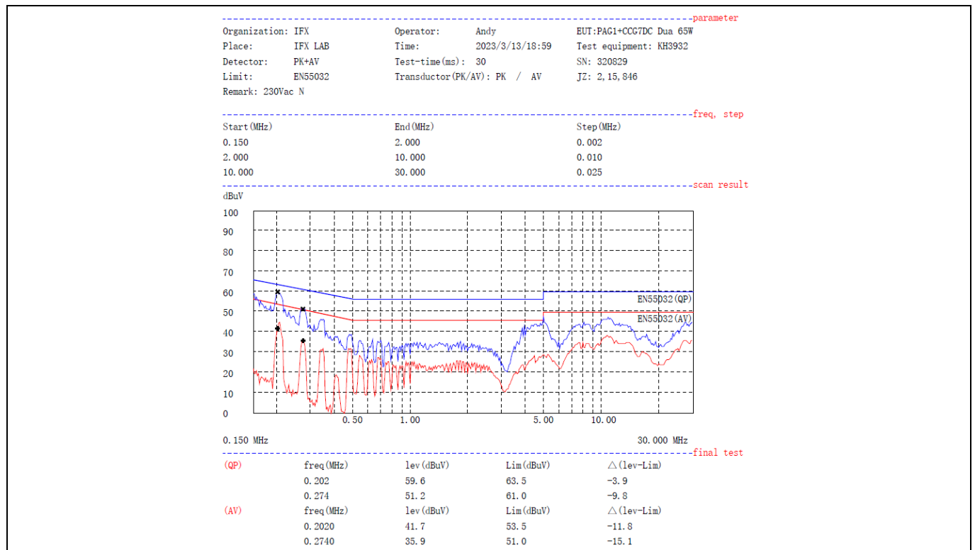
Figure 33 CE at 230 V, 50 Hz: N LINE (QP and AV margin \geq 3.9 dB)
