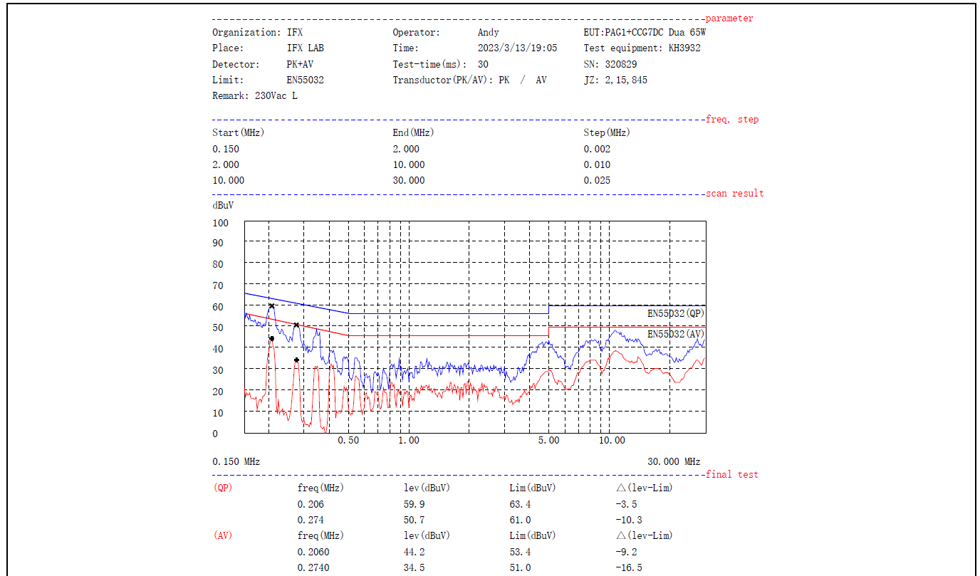
Figure 32 CE at 230 V, 50 Hz: L LINE (QP and AV margin \geq 3.5 dB)
