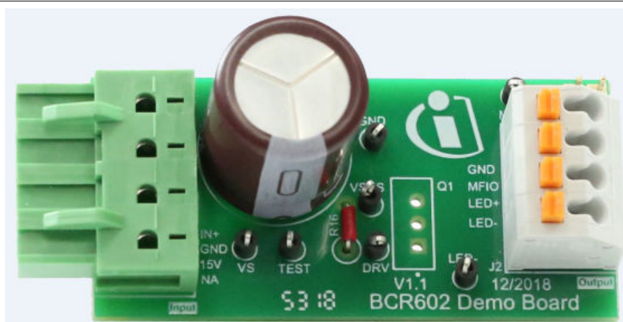
图 2 演示器设计板的顶侧 (56.00 mm x 27.00 mm)
