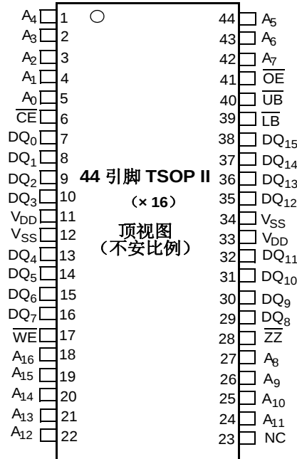
图 1. 44 pin TSOP II 的引脚分配
