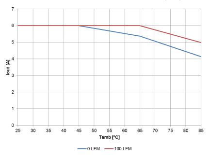
Vin=PVin=12V, Vout1 =3.3V, Vout2=1.8V, lout1 = lout2, VCC=internal LDO (5.3V), Fs = 600kHz
