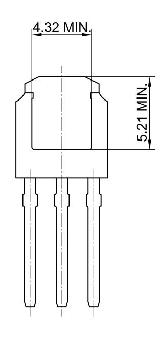
PACKAGE BODY SIZES EXCLUDE MOLD FLASH, PROTRUSION OR GATE BURRS. MOLD FLASH, PROTRUSION OR GATE BURRS SHALL NOT EXCEED 0.10 MM PER SIDE
