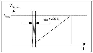
Figure 9 Leading Edge Blanking
