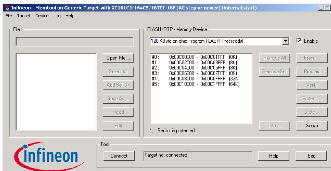
点击‘connect’进行通讯连接。通讯成功之后，按照顺序 open file... – select all – add sel.>>将 h86 文件添加到右边框中，然后选择‘Erase...’和‘Program’进行擦除、编程。如有必要可点击‘Verify’进行校验。
