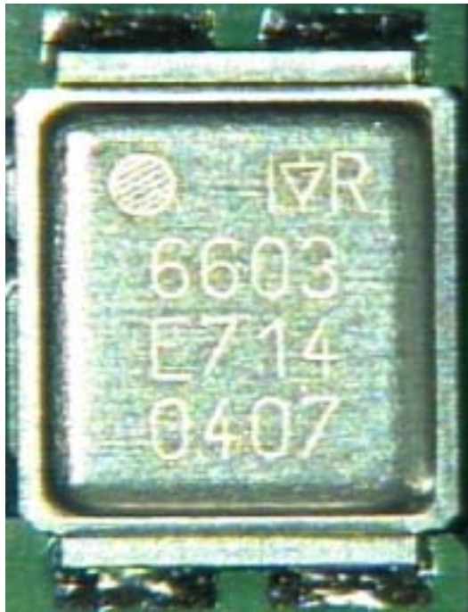
図 4 ヒレ状のはんだ接続がうまくいった場合はデバイスが自動的に中心に配置される
