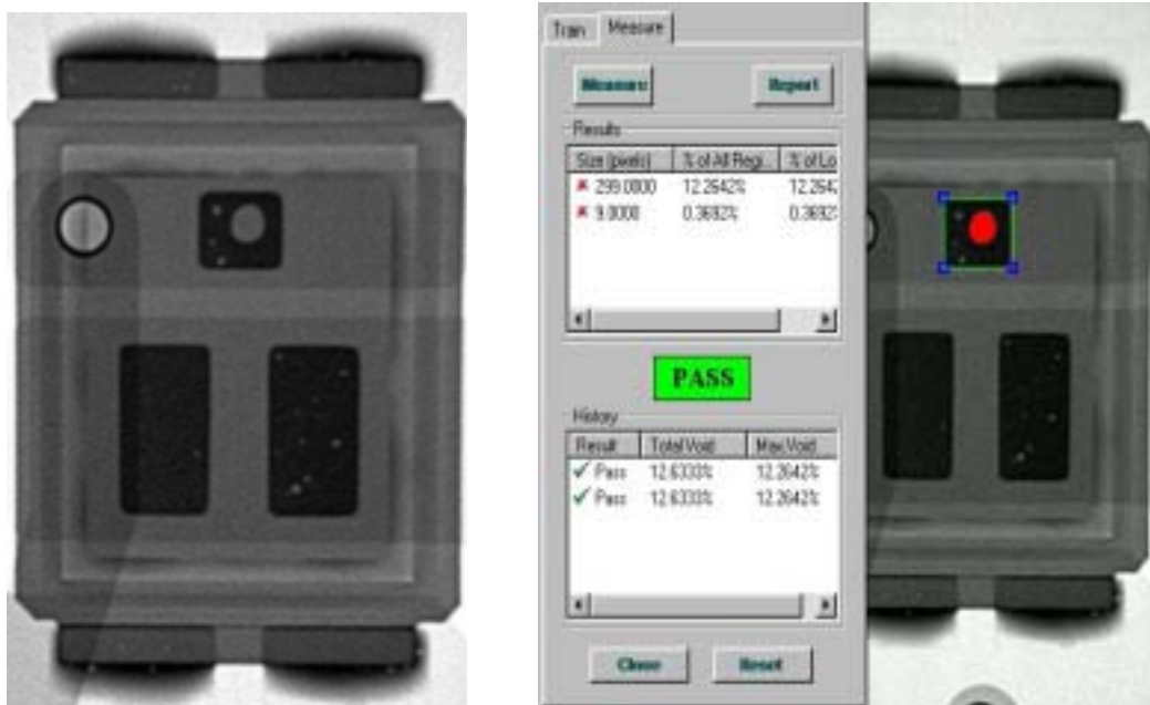
図 12 ゲート接続のはんだボイド
