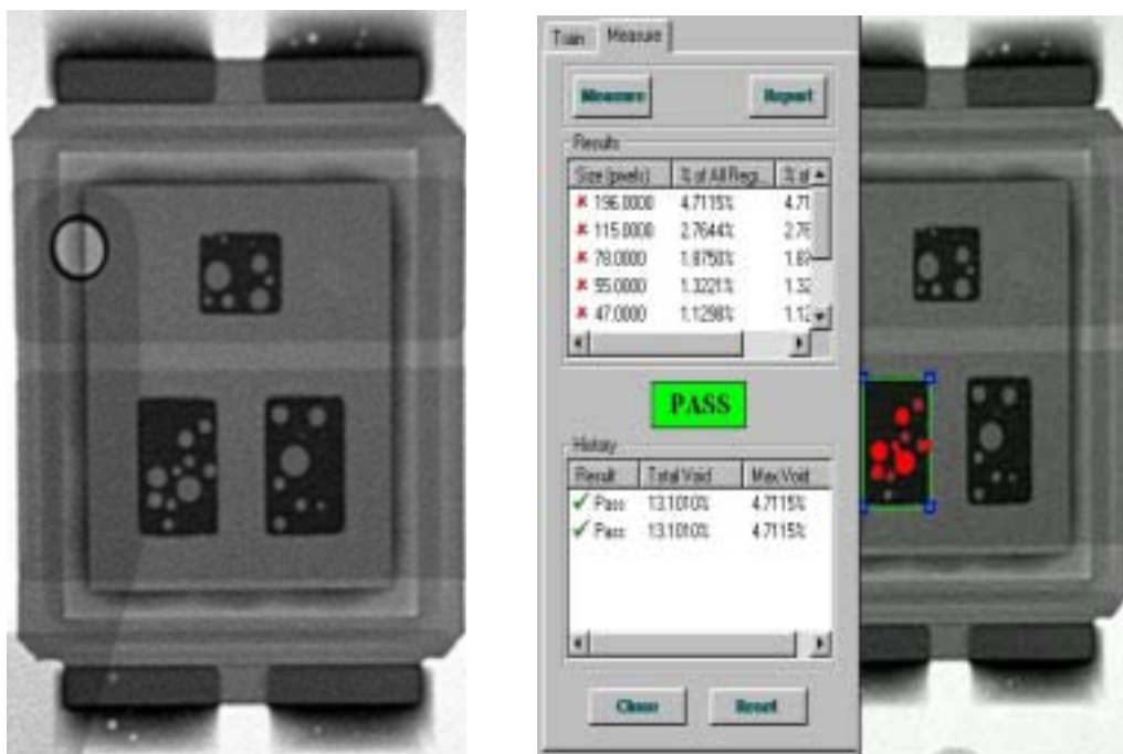
図 13 左のソース接続部のはんだボイド
